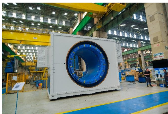
Fertigung rotierender Phasenschieber in der ANDRITZ-Produktionsstätte in Araraquara, Brasilien
