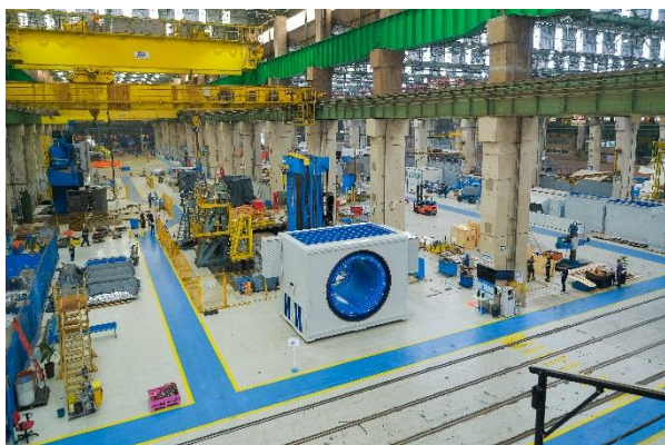
Fertigung rotierender Phasenschieber in der ANDRITZ-Produktionsstätte in Araraquara, Brasilien
